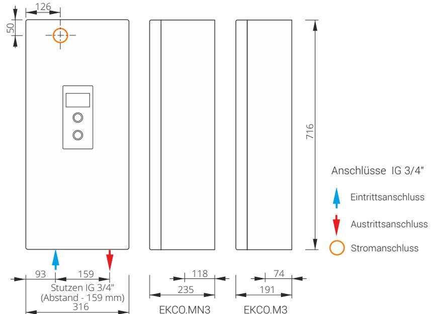
Elektrischer Heizkessel in der Basis-Ausführung
