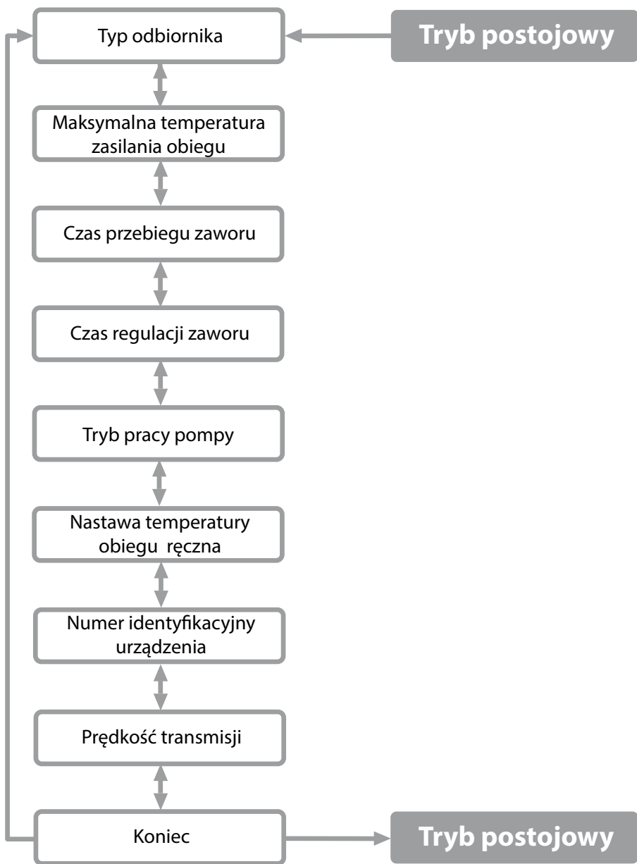
Rys.7 Schemat poruszania się po menu konfiguracyjnym.
