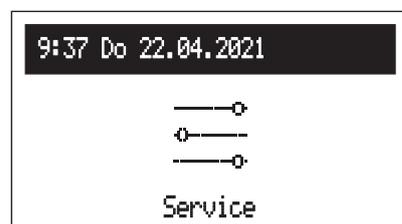
Diagnosewerkzeuge, Zugang für den Installateur und Fachdienste nach Eingabe des Zugangscodes.
