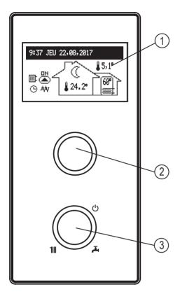
Configurez l'un de modes: hiver \|\|+\frac{\pi}{\pi}\/ été \|\frac{\pi}{\pi}\/ interruption \(\phi\) à l'aide du bouton du choix du mode de travail [3]. Changez les écrans de fonctions sur l'afficheur [1] qui sont au mode actif hiver ou été en tournant le bouton [2] (à gauche ou à droite).
