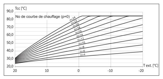
Au cas de la nécessité du déplacement de la courbe de chauffe il faut changer le paramètre [déplacement de la courbe]. Le croquis présente un exemple de la courbe de chauffe no 12 avec le déplacement -10°C et 10°C.
