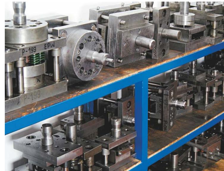
**PL** Kolejnym etapem jest wdrożenie do produkcji. Dział technologiczny opracowuje w najdrobniejszych szczegółach poszczególne etapy produkcji. Jednocześnie narzędziownia przygotowuje przyrządy potrzebne do wyprodukowania poszczególnych elementów urządzenia.
